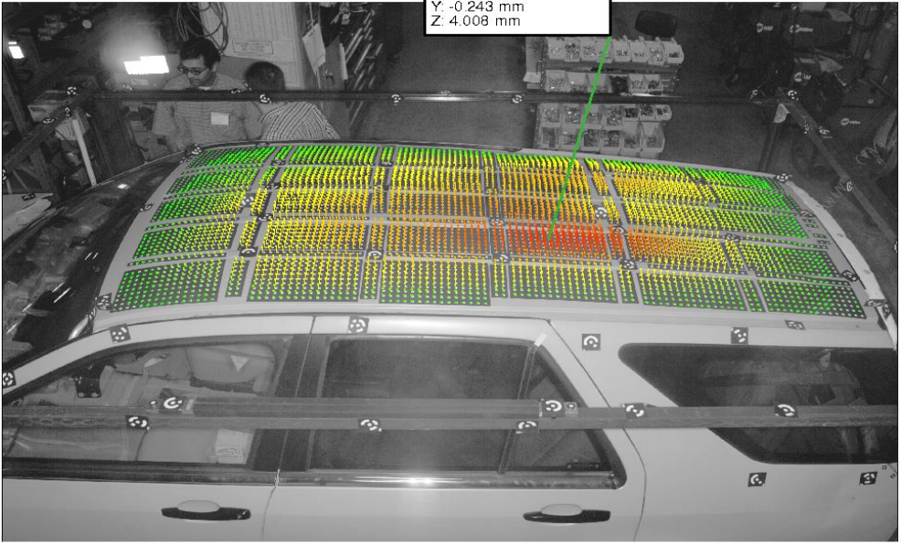
(热应力所造成的整体变形)
